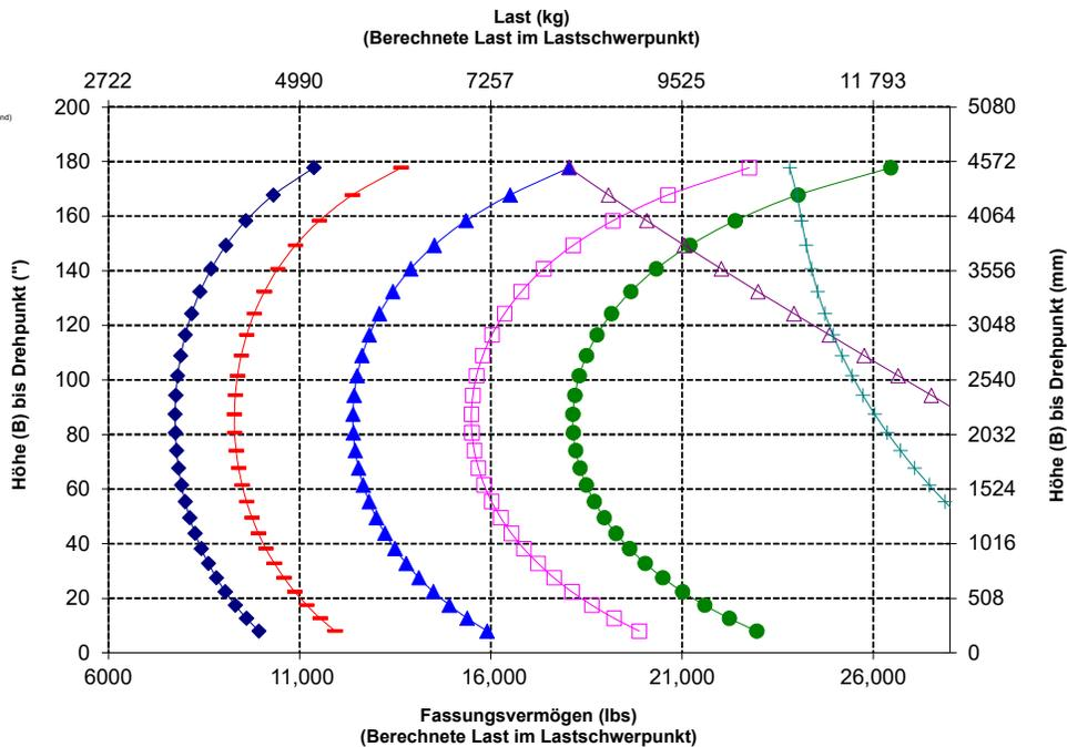
**ANMERKUNG:** Die Angaben zur statischen Kipplast und zum Einsatzgewicht gelten für folgende Laderkonfiguration: Bridgestone VJTL L3 Reifen, Klimaanlage, hydraulische Schwingungsdämpfung, Antriebsstrangschutz, Betriebsflüssigkeiten, Kraftstofftank, Kühlmittel, Schmierstoffe und Fahrer.
