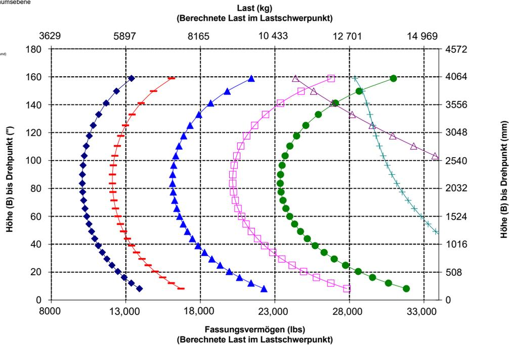
**ANMERKUNG:** Die Angaben zur statischen Kipplast und zum Einsatzgewicht gelten für folgende Laderkonfiguration: Bridgestone VJT L3 Reifen, Klimaanlage, hydraulische Schwingungsdämpfung, Antriebsstrangschutz, Betriebsflüssigkeiten, Kraftstofftank, Kühlmittel, Schmierstoffe und Fahrer.
