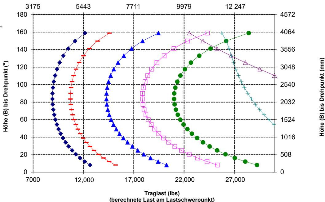
**ANMERKUNG:** Die Angaben zur statischen Kipplast und zum Einsatzgewicht gelten für folgende Laderkonfiguration: Bridgestone VJT L3 Reifen, Klimaanlage, hydraulische Schwingungsdämpfung, Antriebsstrangschutz, Betriebsflüssigkeiten, Kraftstofftank, Kühlmittel, Schmierstoffe und Fahrer.
