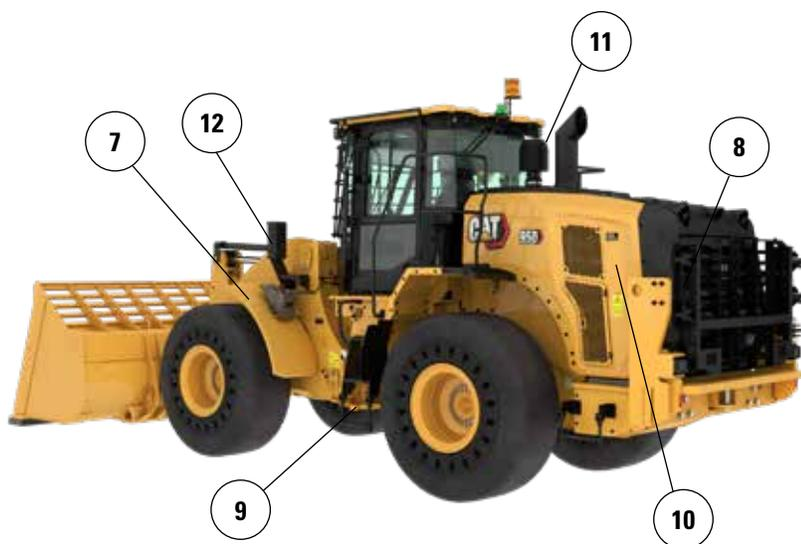
7. Die schmalen vorderen Kotflügel aus Stahl halten den Schmutz von der Windschutzscheibe ab und gewähren zusätzlichen Schutz durch die nach innen gerichtete Montage am äußeren Rand des Reifens.
