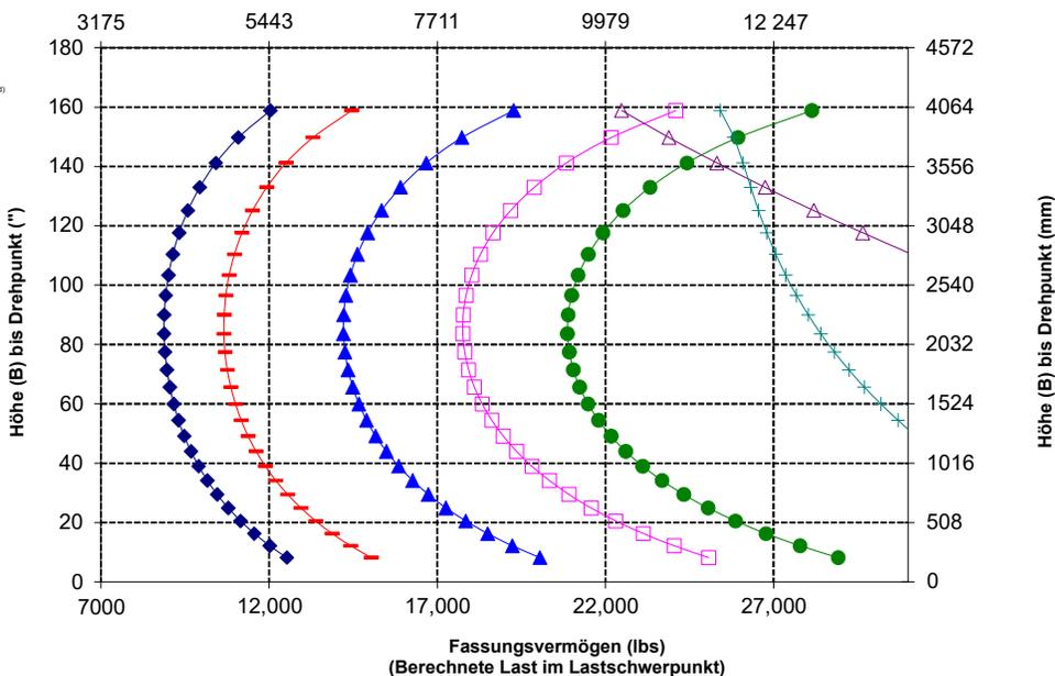
**ANMERKUNG:** Die Angaben zur statischen Kipplast und zum Einsatzgewicht gelten für folgende Laderkonfiguration: Bridgestone VJL3 Reifen, Klimaanlage, hydraulische Schwingungsdämpfung, Antriebsstrangschutz, Betriebsflüssigkeiten, Kraftstofftank, Kühlmittel, Schmierstoffe und Fahrer.
