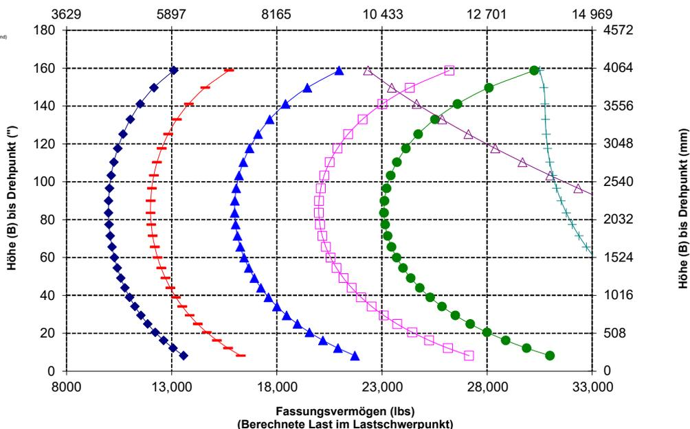
**ANMERKUNG:** Die Angaben zum statischen Kipplast und zum Einsatzgewicht gelten für folgende Laderkonfiguration: Bridgestone VJT L3 Reifen, Klimaanlage, hydraulische Schwingungsdämpfung, Antriebsstrangschutz, Betriebsflüssigkeiten, Kraftstofftank, Kühlmittel, Schmierstoffe und Fahrer.
