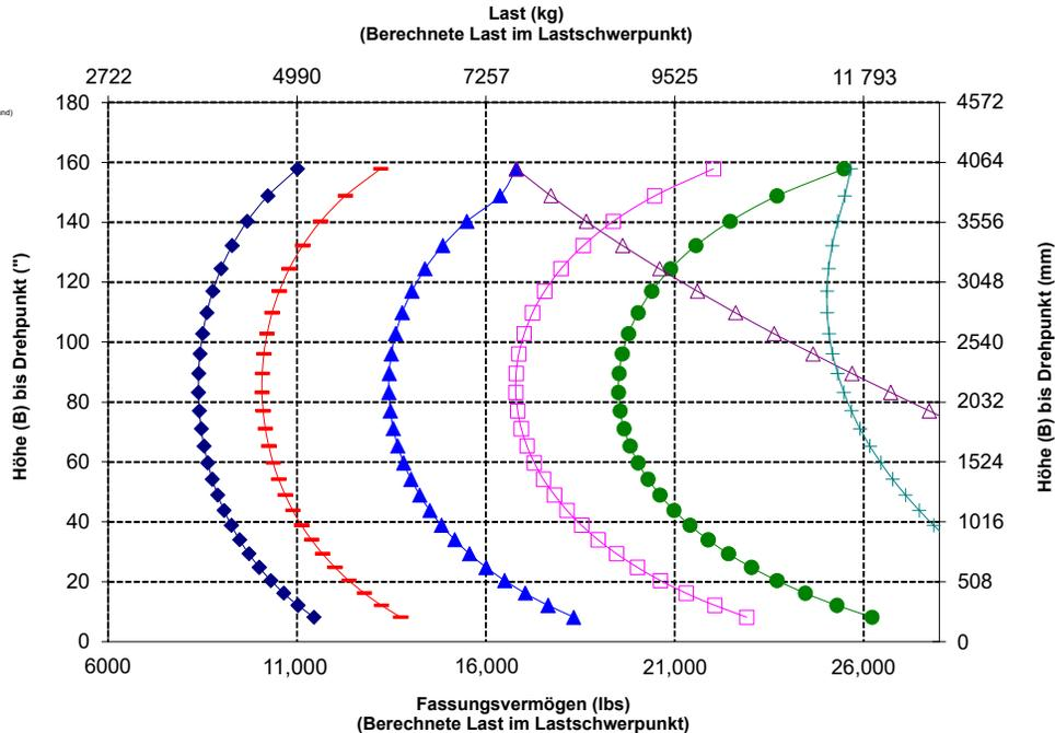
**ANMERKUNG:** Die Angaben zur statischen Kipplast und zum Einsatzgewicht gelten für folgende Laderkonfiguration: Bridgestone VJT L3 Reifen, Klimaanlage, hydraulische Schwingungsdämpfung, Antriebsstrangschutz, Betriebsflüssigkeiten, Kraftstofftank, Kühlmittel, Schmierstoffe und Fahrer.
