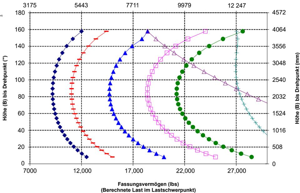
**ANMERKUNG:** Die Angaben zur statischen Kipplast und zum Einsatzgewicht gelten für folgende Laderkonfiguration: Bridgestone VJT L3 Reifen, Klimaanlage, hydraulische Schwinganlage, Antriebsstrangschutz, Betriebsflüssigkeiten, Kraftstofftank, Kühlmittel, Schmierstoffe und Fahrer.
