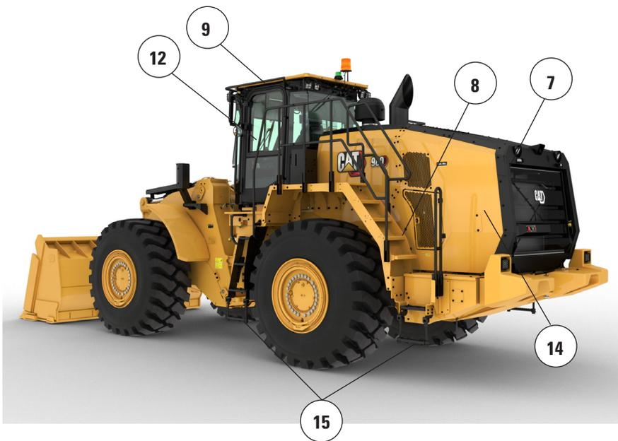
7. Bodennaher Übersteuerungsschalter für die Feststellbremse und Ausschalter für den Motor
