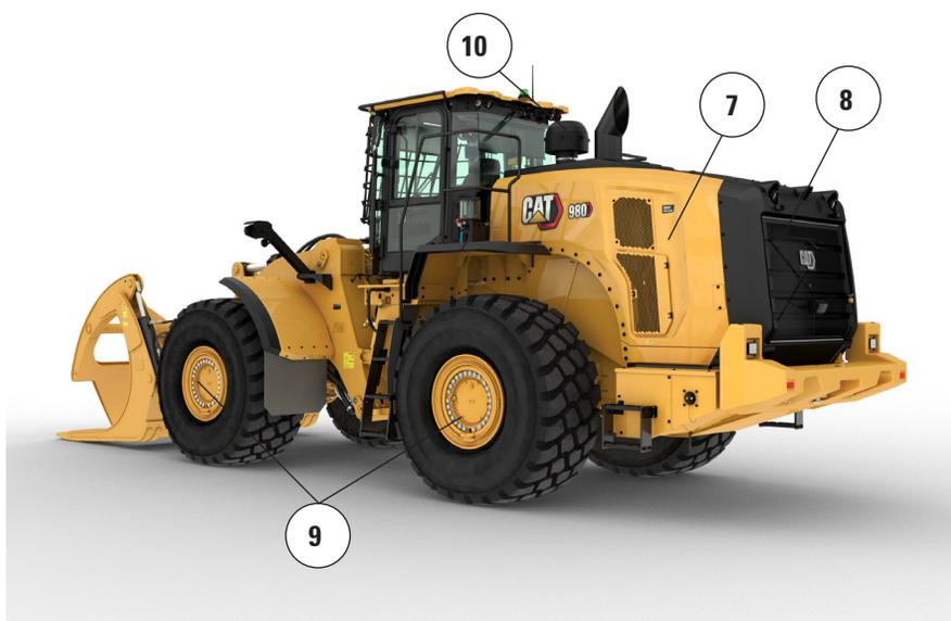
7. Optionaler Verstelllüfter hilft, das hintere Schutzgitter und die Kühlblöcke bei Anwendungen mit starker Verschmutzung sauber zu halten.
