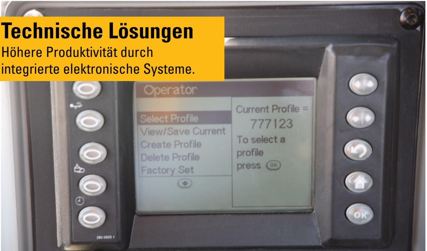
Die elektronischen Systeme des 993K sind vollständig integriert, sodass die Maschine als ein einheitliches System arbeitet. Das Ergebnis dieser Integration sind eine intelligente Maschine und ein besser informierter Fahrer, die beide mit höchster Produktivität arbeiten können.
