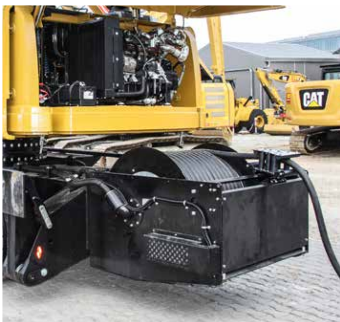
Die optionale Kabeltrommel ist direkt am Unterwagen verbaut. Sie wickelt das Kabel automatisch auf und ab. Die Kabellänge ist 73 m.
