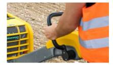
Bedienersicherheit: lässt der Bediener die Führungsdeichsel los, arbeitet die Vibrationsplatte in Standrüttlung weiter
