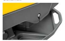
Verzurrmöglichkeiten wie bei Großmaschinen ermöglichen eine optimale Sicherung beim Transport
